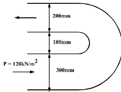
إذا كان معدل التدفق في الأنبوبة يساوي  $20 \text{ Litre/s}$  وكان الضغط عند مدخل الانحناء يساوي  $120 \text{ kN/m}^2$  وحجم الانحناء يساوي  $0.1 \text{ m}^3$  ، ما هو اتجاه ومقدار القوة التي يؤثر بها الماء على الانحناء ؟ (الإجابة :  $12197 \text{ N}$  ،  $\theta = 4.61^\circ$ ).
