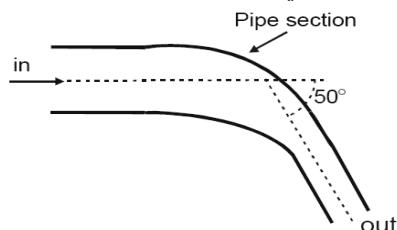
إذا كان الضغط عند الأنبوة الخارجية (Out) يساوي  $200\text{ kPa}$  ، ما هو مقدار القوة اللازمة التي يؤثر بها الماء لكي تعمل على تثبيت المنظومة في مكانها؟ (الإجابة:  $\theta = -71.27^\circ$  و  $F = 33876\text{ N}$ ).
