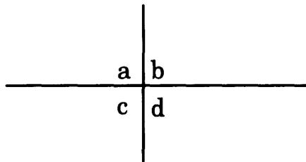
$$a^\circ = b^\circ = c^\circ = d^\circ = 90^\circ$$
