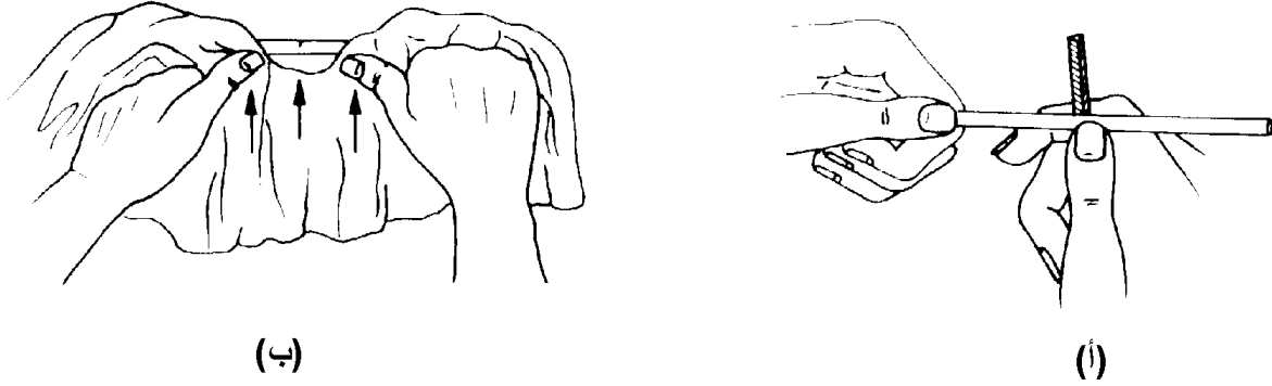
الشكل (٩): الطريقة الصحيحة لقطع أنابيب زجاجية
